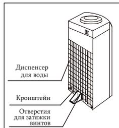
**ПРЕДУПРЕЖДЕНИЕ!** при перемещении или чистке диспенсера извлекайте винты, которыми крепится устройство.
